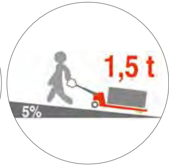
5% Steigfähigkeit bei Volllast
