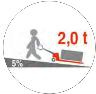
5% Steigfähigkeit bei Volllast
