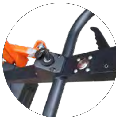
Deichsel mit Schlüsselschalter und Signaltaste
