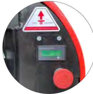
Batterieladestand- und Betriebsstundenanzeige mit Not-Aus-Knopf
