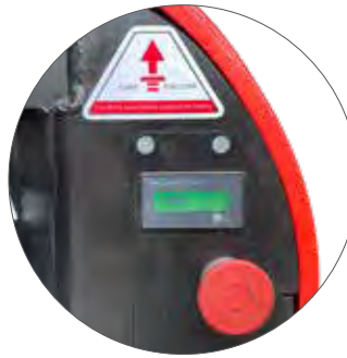
Batterieladestand- und Betriebsstundenanzeige mit Not-Aus-Knopf
