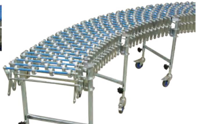
Scheren-Röllchenbahn mit kugelgelagerten und verzinkten Stahlröllchen
