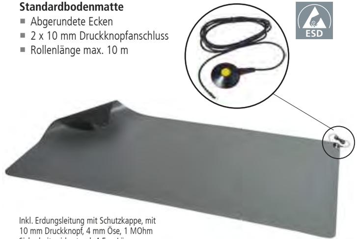
Inkl. Erdungsleitung mit Schutzkappe, mit 10 mm Druckknopf, 4 mm Öse, 1 MΩm Sicherheitswiderstand, 4,5 m Länge
